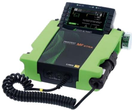
Die MF-Serie ist die Weiterentwicklung der etablierten PROFITEST-Serie, ergänzt mit einem hochauflösenden Farbgrafik-Display, USB Master Schnittstelle und der Datenbank Software IZYTRONIQ – ein deutlicher Schritt vorwärts!
