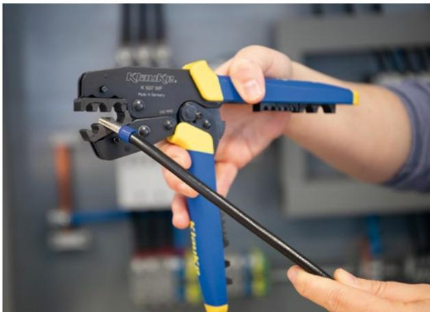
Sie hätten gern ein Werkzeug, mit dem Sie Aderendhülsen möglichst einfach und schnell verpressen können? Dann ist die Klauke K507 WF genau die richtige Lösung für Sie! Hier arbeiten Sie mit auswechselbaren Presseinsätzen für Aderendhülsen. Zum Einsatz kommt das Vierkant-Pressverfahren.
