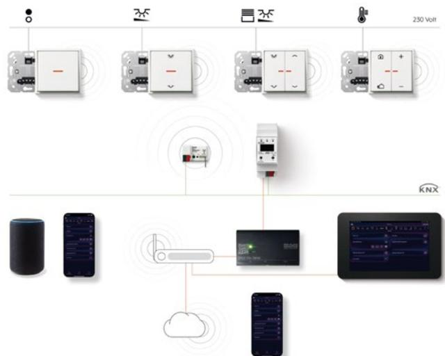
JUNG KNX RF Taster verbinden die klassische Elektroinstallationen mit KNX – drahtlos, ohne zusätzliche Leitungen verlegen zu müssen und sicher verschlüsselt mit Data Secure.
