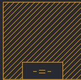
Deckel mit Bodenbelagsausparung und Schnurauslassklappe
