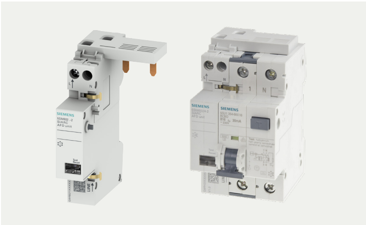
Bild 24: Brandschutzschalter 5SM6021-2 mit und ohne angebaurem FI/LS-Schalter 5SU1
