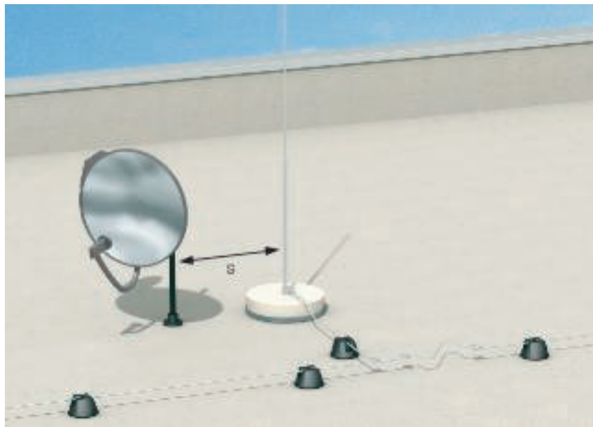
Korrekt eingehaltener Trennungsabstand (s) zwischen Fangeinrichtung und SAT-Anlage
