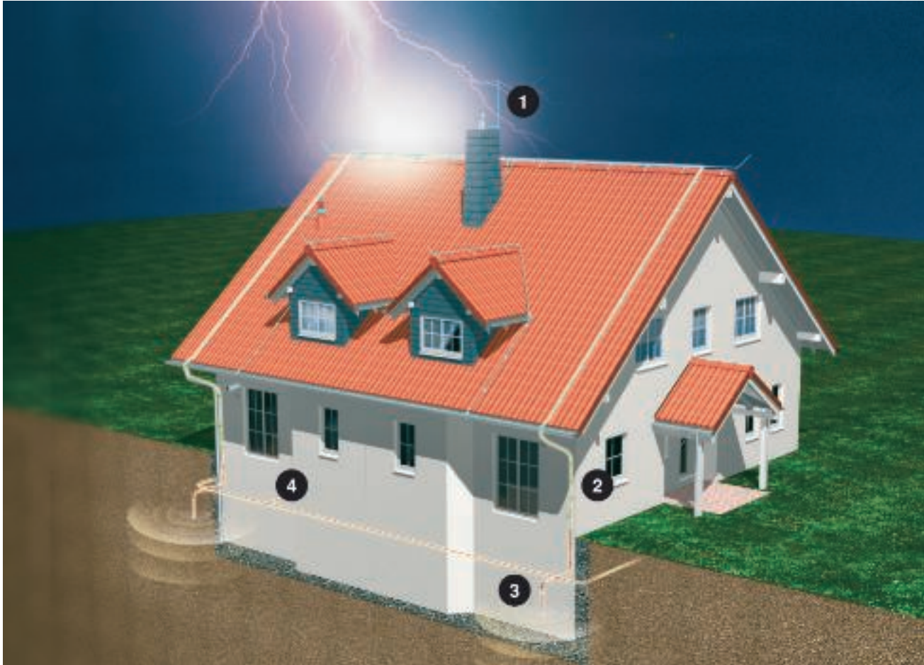
1 = Fangeinrichtung, 2 = Ableitung, 3 = Erdungsanlage, 4 = Potentialausgleich
