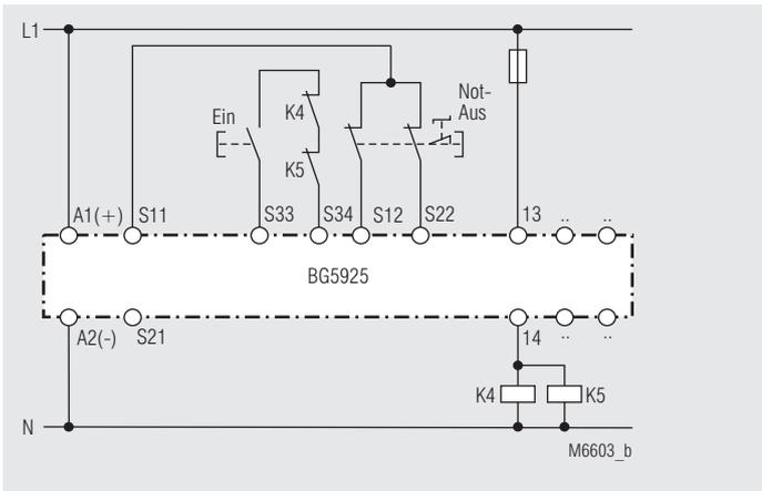
Kontaktverstärkung durch externe Schütze mit einem Kontaktpfad angesteuert.
