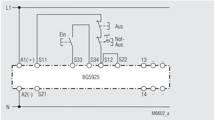
Einkanalige Not-Aus-Schaltung. Diese Schaltung hat keine Redundanz im Not-Aus-Befehlsgeberkreis.
