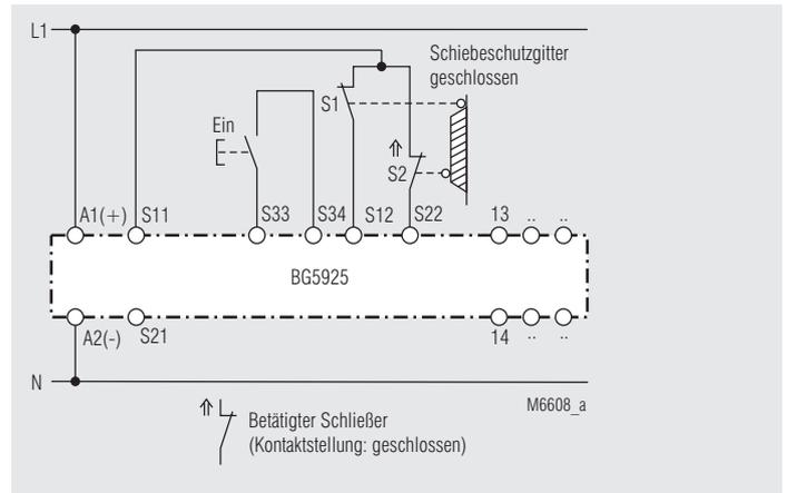
Zweikanalige Überwachung eines Schiebeschutzgitters.
