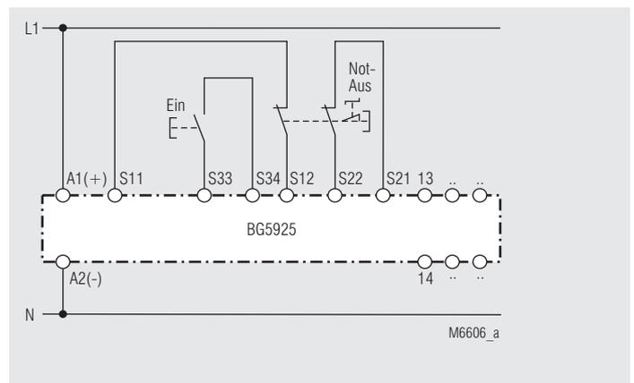
Zweikanalige Not-Aus-Schaltung mit Querschlusserkennung.
