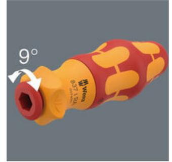
Die integrierte Ratsche mit Feinverzahnung (40 Zähne und ein Rückholwinkel von 9°) vereinfacht und beschleunigt das Schrauben ohne mühsames Neuansetzen.
