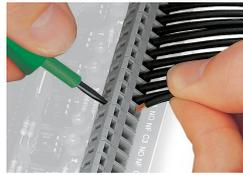
Leiter anschließen – mit Schraubendreher (Klingenbreite 3,5 mm).
