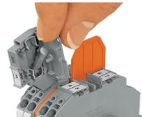
Eine Endplatte für Sicherungsklemmen (hier 2002-1092, orange) dient als zusätzlicher Schutz vor dem Öffnen des Sicherungshalters. Das Auswechseln der Sicherung kann erst erfolgen, nachdem der Sicherungshalter vom Stromkreis getrennt wurde.
