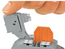
Die Doppelstock-Sicherungsklemme mit schwenkbarem Sicherungshalter (2002-2611, grau) ist kombinierbar mit den Trenn-, Basis-, Durchgangs- und Schutzleiterklemmen. Der Sicherungshalter ist auch mit einer LED-Defektanzeige erhältlich (z. B. 2002-2611/1000-541 für 12 ... 30 V).
