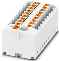
Verteilerblock, Grundklemme mit Einspeisung, Nennspannung: 450 V, Nennstrom: 24 A, Anzahl der Anschlüsse: 19, Anschlussart: Push-in-Anschluss, Abgriff, Querschnitt: 0,14 mm<sup>2</sup> - 4 mm<sup>2</sup>, Push-in-Anschluss, Sammelschluss, Bemessungsquerschnitt: 6 mm<sup>2</sup>, Querschnitt: 0,5 mm<sup>2</sup> - 10 mm<sup>2</sup>, Montageart: aufrasten auf Tragschienenadapter, Direktmontage mit Flansch, Fliegend, Farbe: weiß
