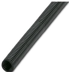
Schutzschlauch, Material: PA 6, UV-beständig: ja, flexibel, Schutzart: IP68, Farbe: schwarz, Brennbarkeitsklasse nach UL 94: HB, Innendurchmesser: 12 mm, Gesamtlänge: 50 m
