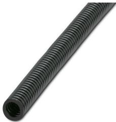
Schutzschlauch, Material: PA 6, UV-beständig: ja, flexibel, Schutzart: IP68, Farbe: schwarz, Brennbarkeitsklasse nach UL 94: V0, Innendurchmesser: 12 mm, Gesamtlänge: 50 m
