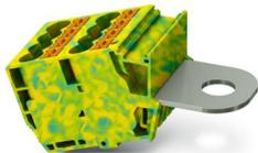
Abgriffklemme, Nennspannung: 1000 V, Nennstrom: 41 A, Anzahl der Anschlüsse: 9, Anschlussart: Push-in-Anschluss, 1. Etage, Bemessungsquerschnitt: 6 mm<sup>2</sup>, Querschnitt: 0,5 mm<sup>2</sup> - 10 mm<sup>2</sup>, Bolzenanschluss, 1. Etage, Montageart: auf Basiselement, Farbe: grün/gelb
