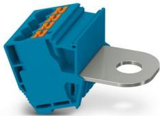
Abgriffklemme, Nennspannung: 1000 V, Nennstrom: 41 A, Anzahl der Anschlüsse: 5, Anschlussart: Push-in-Anschluss, 1. Etage, Bemessungsquerschnitt: 6 mm<sup>2</sup>, Querschnitt: 0,5 mm<sup>2</sup> - 10 mm<sup>2</sup>, Bolzenanschluss, 1. Etage, Montageart: auf Basiselement, Farbe: blau
