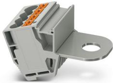
Abgriffklemme, Nennspannung: 1000 V, Nennstrom: 41 A, Anzahl der Anschlüsse: 5, Anschlussart: Push-in-Anschluss, 1. Etage, Bemessungsquerschnitt: 6 mm<sup>2</sup>, Querschnitt: 0,5 mm<sup>2</sup> - 10 mm<sup>2</sup>, Bolzenanschluss, Sammelanschluss, Montageart: auf Basiselement, Farbe: grau
