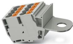
Abgriffklemme, Nennspannung: 1000 V, Nennstrom: 41 A, Anzahl der Anschlüsse: 9, Anschlussart: Push-in-Anschluss, 1. Etage, Bemessungsquerschnitt: 6 mm<sup>2</sup>, Querschnitt: 0,5 mm<sup>2</sup> - 10 mm<sup>2</sup>, Bolzenanschluss, 1. Etage, Montageart: auf Basiselement, Farbe: grau
