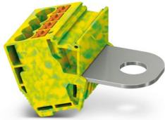
Abgriffklemme, Nennspannung: 1000 V, Nennstrom: 41 A, Anzahl der Anschlüsse: 5, Anschlussart: Push-in-Anschluss, 1. Etage, Bemessungsquerschnitt: 6 mm<sup>2</sup>, Querschnitt: 0,5 mm<sup>2</sup> - 10 mm<sup>2</sup>, Bolzenanschluss, 1. Etage, Montageart: auf Basiselement, Farbe: grün-gelb
