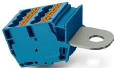
Abgriffklemme, Nennspannung: 1000 V, Nennstrom: 41 A, Anzahl der Anschlüsse: 9, Anschlussart: Push-in-Anschluss, 1. Etage, Bemessungsquerschnitt: 6 mm<sup>2</sup>, Querschnitt: 0,5 mm<sup>2</sup> - 10 mm<sup>2</sup>, Bolzenanschluss, 1. Etage, Montageart: auf Basiselement, Farbe: blau
