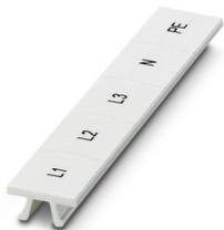
Zackband, Streifen, weiß, beschriftet, längs bedruckt: L1, L2, L3, N, PE, Montageart: verrasten, für Klemmenbreite: 12,2 mm, Schriftfeldgröße: 10,5 x 12,15 mm, Anzahl der Einzelschilder: 5
