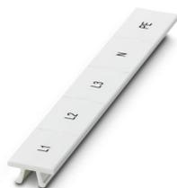
Zackband, Streifen, weiß, beschriftet, längs bedruckt: L1, L2, L3, N, PE, Montageart: verrasten, für Klemmenbreite: 16,3 mm, Schriftfeldgröße: 10,5 x 16,25 mm, Anzahl der Einzelschilder: 5
