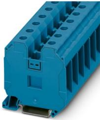
Durchgangsklemme, mit Innensechskantschrauben, Nennspannung: 1000 V, Nennstrom: 125 A, Anzahl der Anschlüsse: 2, Anschlussart: Schraubanschluss, Bemessungsquerschnitt: 35 mm<sup>2</sup>, Querschnitt: 1,5 mm<sup>2</sup> - 50 mm<sup>2</sup>, Montageart: NS 35/7,5, NS 35/15, Farbe: blau
