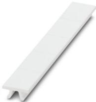
Zackband, Streifen, weiß, unbeschriftet, beschriftbar mit: PLOTMARK, CMS-P1-PLOTTER, Montageart: verrasten, für Klemmenbreite: 16 mm, Schriftfeldgröße: 16 x 10,5 mm, Anzahl der Einzelschilder: 50
