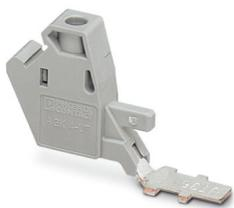
Abgriffklemme, Nennspannung: 1000 V, Nennstrom: 32 A, Anzahl der Anschlüsse: 1, Anschlussart: Schraubanschluss, Querschnitt: 0,14 mm<sup>2</sup> - 6 mm<sup>2</sup>, Montageart: auf Basiselement, Farbe: grau
