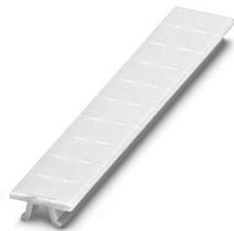
Marker für Klemmen, Streifen, weiß, beschriftet, beschriftbar mit: CMS-P1-PLOTTER, längs bedruckt: U, V, W, N, GND, U, V, W, N, GND, Montageart: verrasten, für Klemmenbreite: 6,2 mm, Schriftfeldgröße: 6,15 x 10,5 mm, Anzahl der Einzelschilder: 10
