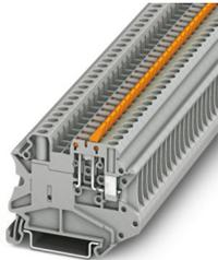
Messertrennklemme, mit Betätigungsflasche und Prüfbuchschrauben zur Aufnahme von Prüfsteckern, Nennspannung: 500 V, Nennstrom: 20 A, Anschlussart: Schraubanschluss, Bemessungsquerschnitt: 2,5 mm<sup>2</sup>, Querschnitt: 0,14 mm<sup>2</sup> - 6 mm<sup>2</sup>, Montage: NS 35/7,5, NS 35/15, Farbe: grau
