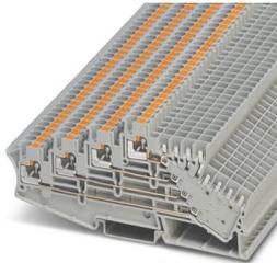
Mehrstockklemme, Nennspannung: 250 V, Nennstrom: 10 A, Anzahl der Anschlüsse: 12, Anschlussart: Push-in- / Steckanschluss, Bemessungsquerschnitt: 2,5 mm<sup>2</sup>, Querschnitt: 0,14 mm<sup>2</sup> - 4 mm<sup>2</sup>, Montageart: NS 35/7,5, NS 35/15, Farbe: grau
