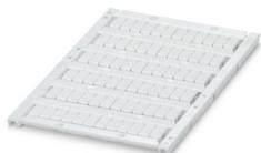
Marker für Klemmen, Matte, weiß, unbeschriftet, beschriftbar mit: TOPMARK NEO, TOPMARK LASER, BLUEMARK ID COLOR, BLUEMARK ID, BLUEMARK CLED, THERMOMARK PRIME, THERMOMARK CARD 2.0, THERMOMARK CARD, Montageart: verrasten, für Klemmenbreite: 5,2 mm, Schriftfeldgröße: 4,6 x 10,5 mm, Anzahl der Einzelschilder: 72
