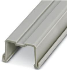
Abdeckprofil, zum Abdecken von Klemmenleisten, wird auf Abdeckprofilträger APT-ME oder Endhalter APH-ME gerastert. An den Enden und in Abständen von ca. 40 cm ist ein Abdeckprofilträger zu setzen. Länge nach Kundenwunsch.
