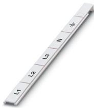
Marker für Klemmen, Streifen, weiß, beschriftet, längs: L1, L2, L3, N, GND, Montageart: verrasten, für Klemmenbreite: 18 mm, Schriftfeldgröße: 18 x 5 mm, Anzahl der Einzelschilder: 5
