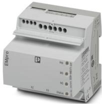
Multifunktionales Energiemessgerät ohne Display mit direktem Rogowski-Anschluss und integrierter Modbus TCP- und Ethernet/IP-Schnittstelle zur Messung elektrischer Parameter in Niederspannungsanlagen bis 690 V. ([phoenixcontact.com/empro-help](https://www.phoenixcontact.com/empro-help))
