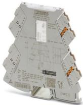
Universell-konfigurierbarer Temperaturgrenzwertschalter mit Schließerrelaisausgang für den Anschluss von 2-, 3-, 4-Leiter Widerstandsthermometern und Thermoelementen. Konfigurierbar über DIP-Schalter oder Software. Push-in-Anschlussstechnik
