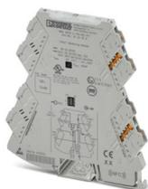
Fault-Monitoring-Modul mit steckbarer Anschlusstechnik zur Auswertung und Meldung der Sammelfehler des FM-Systems und zur Überwachung der Versorgungsspannungen. Fehlermeldung über Öffnerkontakt. Push-in-Anschlusstechnik, Standardkonfiguration
