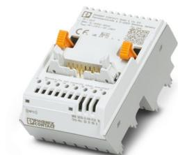
Acht MINI Analog Pro Trennverstärker und Messumformer können mittels Systemadapter und Systemverkabelung mit geringstem Verkabelungsaufwand und völlig fehlerfrei an eine Steuerung angebunden werden.
