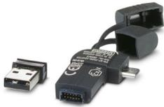
Bluetooth-Adapter mit Micro-USB- und S-PORT-Schnittstelle zur drahtlosen Kommunikation mit den Geräteserien MINI Analog, MINI Analog Pro, MACX Analog, Interface-System-Gateways und PLC logic.
