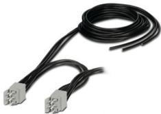
Schleifenbrücke 3-phasig für 4 Module der CONTACTRON-Familie mit Push-in-Anschluss und 22,5 mm Gehäusebreite, Leitungslänge zwischen den Modulen: 0,3 m, Anschlussleitung: 2 m
