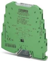
Das Fault-Monitoring-Modul dient zur Auswertung und Meldung der Sammelfehler des Fault-Monitoring-Systems und zur Überwachung der Versorgungsspannungen. Die Fehlermeldung erfolgt über einen Schließkontakt. Schraubanschluss, Standardkonfiguration.
