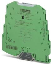
Konstantspannungsquelle, Eingangsspannung 9,6 V DC ... 30 V DC, Ausgangsspannung 10 V, 7,5 V, 5 V, 2,5 V DC, galvanisch getrennt, über DIP-Schalter konfigurierbar, Schraubanschlusstechnik, Standardkonfiguration
