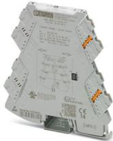
Konstantspannungs-/stromquelle mit steckbarer Anschluss-technik, Eingangsspannung 9,6 V DC ... 30 V DC. Ausgangsspannung 1,25 V DC ... 10 V DC oder Ausgangsstrom 2,5 mA ... 20 mA einstellbar. Konfigurierbar über DIP-Schalter. Push-in-Anschluss-technik.
