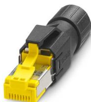
RJ45-Steckverbinder, Bauform: RJ45, Schutzart: IP20, Polzahl: 8, 10 GBit/s, CAT6<sub>A</sub>, Material: Kunststoff, Anschlussart: Schneidklemmanschluss, Anschlussquerschnitt: AWG 26- 24, Kabelabgang: gerade, Farbe: schwarz, Ethernet
