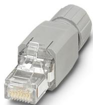
RJ45-Steckverbinder, Bauform: RJ45, Schutzart: IP20, Polzahl: 4, 100 MBit/s, CAT5, Material: Kunststoff, Anschlussart: Schneidklemmanschluss, Kabelabgang: gerade, Farbe: verkehrsgrau A RAL 7042, PROFINET
