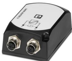
Passiver Netzwerkisolator zur galvanischen Trennung in Ethernet-Netzwerken. Zum Schutz von Ethernet-Geräten vor Potenzialunterschieden bis 4 kV. Einsetzbar für Übertragungsraten bis 100 MBit/s. Ethernet-Anschluss über zwei M12-Buchsen (D-kodiert).
