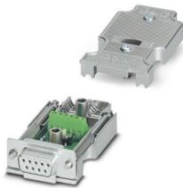
D-SUB-Stecker, 9-polige Buchse, axiale Ausführung mit zwei Kabelzuführungen, Bussystem: CAN, CANopen, SafetyBus-P; Pinbelegung: 2,3,7; Schraubanschlussklemmen
