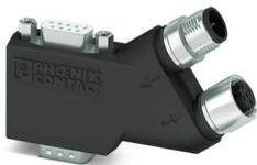
D-SUB-Stecker, 9-polig, Buchse, mit PG-D-SUB-Stift, Belegung: 2, 3, 5, 7, 9; zwei M12-Kabelzuführungen (A-kodiert) unter 35°. Bussystem: CAN, CANopen®. Abschlusswiderstand über separaten M12-Terminator.
