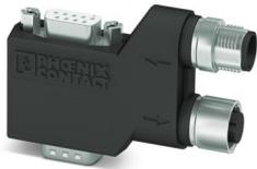
D-SUB-Stecker, 9-polig, Buchse, mit PG-D-SUB-Stift, Belegung: 2, 3, 5, 7, 9; zwei M12-Kabelzuführungen (A-kodiert) unter 90°. Bussystem: CAN, CANopen®. Abschlusswiderstand über separaten M12-Terminator.
