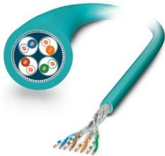
Datenkabel, Ethernet CAT6<sub>A</sub> (10 GBit/s), 8-polig, PUR halogenfrei, wasserblau RAL 5021, geschirmt (Geflecht aus verzinnerten Kupferdrähten), freies Leitungsende, auf freies Leitungsende, Kabellänge: Freie Eingabe (0,5 ... 400 m)
