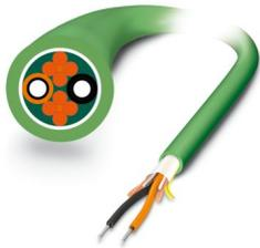
Konfektionierbare, hochflexible POF-PROFINETleitung (nur IP20-Köpfe), für den Einsatz in Schleppketten. Einzelelemente aus hochstrapazierfähigem Polyamid (PA). Die Leitung ist halogenfrei, Ozon- und UV-beständig, mit robustem Polyurethan (PUR) Außenmantel.
