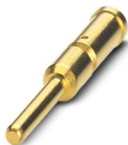
Crimpkontakt, Stift, gedreht, Einzelkontakt, Kontaktdurchmesser: 2 mm, Crimpbereich: 1,5 mm<sup>2</sup> ... 2,5 mm<sup>2</sup>, Alternativprodukt nach RoHS II ohne Ausnahme 6c (Pb < 0,1 %) Art.-Nr.: 1238179
