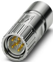
M23, Kabelsteckverbinder, Serie: M23 PRO, gerade lang, geschirmt: ja, Schraubverriegelung, Polzahl: 5+PE, Kontaktart: Stift, Crimpanschluss, Kabeldurchmesserbereich: 9,5 mm ... 14,5 mm, Artikel ist bleifrei nach RoHS II ohne Ausnahme 6c (Pb < 0,1 %)
