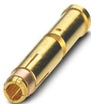
Crimpkontakt, Buchse, gedreht, Kontaktdurchmesser: 2 mm, Crimpbereich: 1,5 mm<sup>2</sup> ... 2,5 mm<sup>2</sup>, Alternativprodukt nach RoHS II ohne Ausnahme 6c (Pb < 0,1 %) Art.-Nr.: 1244461
