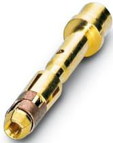
Crimpkontakt, Buchse, gedreht, Kontaktdurchmesser: 1 mm, Crimpbereich: 0,25 mm<sup>2</sup> ... 1 mm<sup>2</sup>, Alternativprodukt nach RoHS II ohne Ausnahme 6c (Pb < 0,1 %)
