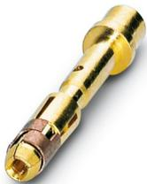
Crimpkontakt, Buchse, gedreht, Einzelkontakt, Kontaktdurchmesser: 1 mm, Crimpbereich: 0,06 mm<sup>2</sup> ... 0,25 mm<sup>2</sup>, Alternativprodukt nach RoHS II ohne Ausnahme 6c (Pb < 0,1 %) Art.-Nr.: 1243216
