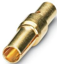
Crimpkontakt, Buchse, gedreht, Kontaktdurchmesser: 2 mm, Crimpbereich: 1,5 mm<sup>2</sup> ... 2,5 mm<sup>2</sup>, Alternativprodukt nach RoHS II ohne Ausnahme 6c (Pb < 0,1 %) Art.-Nr.: 1241635
