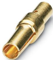
Crimpkontakt, Buchse, gedreht, Einzelkontakt, Kontaktdurchmesser: 2 mm, Crimpbereich: 0,75 mm<sup>2</sup> ... 1 mm<sup>2</sup>, Alternativprodukt nach RoHS II ohne Ausnahme 6c (Pb < 0,1 %) Art.-Nr.: 1241633
