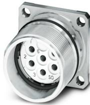
M23, Gerätesteckverbinder Vorderwand, Serie: CA, gerade, geschirmt: ja, für Standard- und SPEEDCON-Verriegelung, Polzahl: 6, Drehsinn: Standard, Kontaktart: Buchse, Crimpanschluss, Flachdichtung, 4x Ø 3,2, Flanschmaß: 25 mm x 25 mm, Kodierung: N
