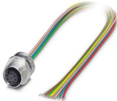
Gerätesteckverbinder Vorderwand, Universal, 8-polig, Buchse, gerade, M12-Standard, Kodierung: A, auf freies Leitungsende, Vorderwandmontage, Pg9, Einzellitzen, Kabellänge: 0,5 m, 0,25 mm<sup>2</sup>, TPE-Litze, Alternativprodukt nach RoHS II ohne Ausnahme 6c (Pb < 0,1 %) Art.-Nr.: 1239865
