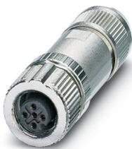
Datensteckverbinder, CANopen<sup>®</sup>, DeviceNet<sup>™</sup>, 5-polig, geschirmt, Buchse gerade M12, Kodierung: A, Push-Lock-Federanschluss, Rändelmaterial: Zinkdruckguss, vernickelt, Leitungsaußendurchmesser 4 mm ... 8 mm
