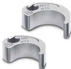
Steckaufsatz zur Montage von Sensor-/Aktor-Kabeln mit M12-Steckverbinder und von konfektionierbaren M12-Steckverbindern, mit Rändeldurchmesser 15 mm, für 4 mm Sechskantantrieb
