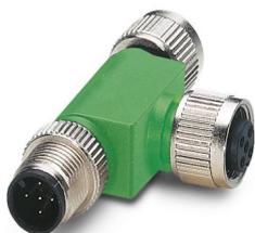
T-Verteiler, 5-polig, Stecker gerade M12, Kodierung: A, auf Buchse gerade M12, Kodierung: A und Buchse gerade M12, Kodierung: A, parallel Verteiler
