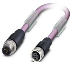
Bussystem-Kabel, CANopen<sup>®</sup>, DeviceNet<sup>™</sup>, 5-polig, PUR halogenfrei, violett RAL 4001, geschirmt (Geflecht aus verzinnnten Kupferdrähten), Stecker gerade M12, Kodierung: A, auf Buchse gerade M12, Kodierung: A, Kabellänge: Freie Eingabe (0,2 ... 40,0 m)
