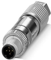
Datensteckverbinder, CANopen<sup>®</sup>, DeviceNet<sup>™</sup>, 5-polig, halogenfrei, geschirmt, Stecker gerade M12, Kodierung: A, Schneidklemmanschluss, Rändelmaterial: Zinkdruckguss, vernickelt, Leitungsaußendurchmesser 5 mm ... 9,7 mm
