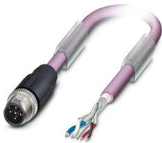
Bussystem-Kabel, CANopen<sup>®</sup>, DeviceNet<sup>™</sup>, 5-polig, PUR halogenfrei, violett RAL 4001, geschirmt (Geflecht aus verzinnnten Kupferdrähten), Stecker gerade M12, Kodierung: A, auf freies Leitungsende, Kabellänge: Freie Eingabe (0,2 ... 40,0 m)
