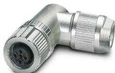
Datensteckverbinder, CANopen<sup>®</sup>, DeviceNet<sup>™</sup>, 5-polig, geschirmt, Buchse gewinkelt M12, Kodierung: A, Push-Lock-Federanschluss, Rändelmaterial: Zinkdruckguss, vernickelt, Leitungsaußendurchmesser 4 mm ... 8 mm
