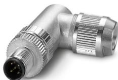
Datensteckverbinder, CANopen<sup>®</sup>, DeviceNet<sup>™</sup>, 5-polig, geschirmt, Stecker gewinkelt M12, Kodierung: A, Push-Lock-Federanschluss, Rändelmaterial: Zinkdruckguss, vernickelt, Leitungsaußendurchmesser 4 mm ... 8 mm
