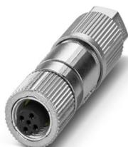
Datensteckverbinder, CANopen<sup>®</sup>, DeviceNet<sup>™</sup>, 5-polig, halogenfrei, geschirmt, Buchse gerade M12, Kodierung: A, Schneidklemmanschluss, Rändelmaterial: Zinkdruckguss, vernickelt, Leitungsaußendurchmesser 5 mm ... 9,7 mm
