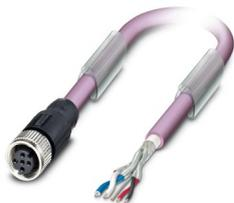
Bussystem-Kabel, CANopen<sup>®</sup>, DeviceNet<sup>™</sup>, 5-polig, PUR halogenfrei, violett RAL 4001, geschirmt (Geflecht aus verzinnnten Kupferdrähten), freies Leitungsende, auf Buchse gerade M12, Kodierung: A, Kabellänge: Freie Eingabe (0,2 ... 40,0 m)
