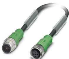
Sensor-/Aktor-Kabel, 3-polig, PUR halogenfrei, schwarzgrau RAL 7021, Stecker gerade M12, Kodierung: A, auf Buchse gerade M12, Kodierung: A, Kabellänge: 10 m, für Ventilstecker
