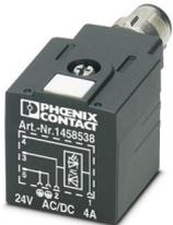
Ventilstecker, 3-polig, Stecker gewinkelt M12 SPEEDCON, Kodierung: A, auf Ventilstecker A, mit 1 LED, Beschaltung: Z-Diode
