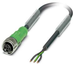
Anschlusskabel, 3-polig, freies Leitungsende, auf Buchse gerade M12 SPEEDCON, Kodierung: A, Kabellänge: Freie Eingabe (0,2 ... 40,0 m), für Ventilsteckeradapter
