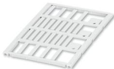
Leitermarker, Matte, weiß, unbeschriftet, beschriftbar mit: BLUEMARK ID COLOR, BLUEMARK ID, BLUEMARK CLED, PLOTMARK, CMS-P1-PLOTTER, Montageart: einschieben, Kabeldurchmesserbereich: 1,5 ... 35 mm, Schriftfeldgröße: 23 x 4 mm, Anzahl der Einzelschilder: 24
