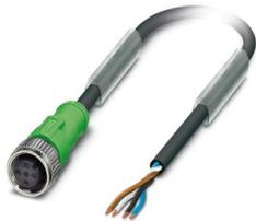
Sensor-/Aktor-Kabel, 4-polig, PVC, schwarz RAL 9005, freies Leitungsende, auf Buchse gerade M12, Kodierung: A, Kabellänge: 10 m
