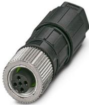
Steckverbinder, Universal, 5-polig, Buchse gerade M12, Kodierung: A, Schneidklemmanschluss, Rändelmaterial: Zinkdruckguss, vernickelt, Leitungsaußendurchmesser 4 mm ... 7 mm
