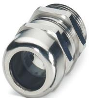
Kabelverschraubung, Material Verschraubung: Messing, vernickelt, Anwendung: EMV, Kabelaußendurchmesser 13 mm ... 18 mm, Schirmung: ja, Anschlussgewinde: Pg21, Farbe: silberfarben, mit O-Ring
