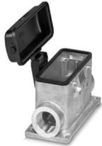
Sockelgehäuse B16, für Querbügel, Material: Aluminiumdruckguss, seewasserbeständig, Material Schutzdeckel: PC, Kabelabgänge: 2, seitlich, 2x Pg21, Höhe: 68 mm, Kabelverschraubung: ohne, Schutzdeckel: ja, Standard
