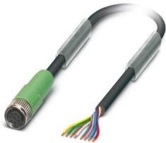
Sensor-/Aktor-Kabel, 8-polig, PUR halogenfrei, schwarzgrau RAL 7021, freies Leitungsende, auf Buchse gerade M8, Kodierung: A, Kabellänge: 10 m
