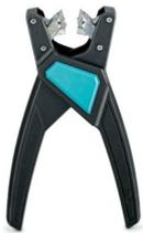
Abisolierzange, für halogenfreie Sensor-/Aktor-Leitungen (SAC-Leitungen), mit PUR und PVC Isolierung, von Ø 3,2 bis 4,4 mm, Abisolierlänge beliebig
