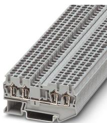
Durchgangsklemme, Nennspannung: 800 V, Nennstrom: 24 A, Anzahl der Anschlüsse: 4, Anschlussart: Zugfederanschluss, Bemessungsquerschnitt: 2,5 mm<sup>2</sup>, Querschnitt: 0,08 mm<sup>2</sup> - 4 mm<sup>2</sup>, Montageart: NS 35/7,5, NS 35/15, Farbe: grau
