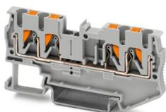
Durchgangsklemme, Nennspannung: 800 V, Nennstrom: 24 A, Anzahl der Anschlüsse: 4, Anschlussart: Push-in-Anschluss, Bemessungsquerschnitt: 2,5 mm<sup>2</sup>, Querschnitt: 0,14 mm<sup>2</sup> - 4 mm<sup>2</sup>, Montageart: NS 35/7,5, NS 35/15, Farbe: grau
