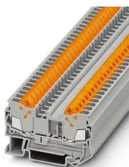
Durchgangsklemme, Nennspannung: 800 V, Nennstrom: 24 A, Anzahl der Anschlüsse: 2, Anschlussart: Schnellanschluss, 1. Etage, Bemessungsquerschnitt: 2,5 mm<sup>2</sup>, Querschnitt: 0,5 mm<sup>2</sup> - 2,5 mm<sup>2</sup>, Montageart: NS 35/7,5, NS 35/15, Farbe: grau
