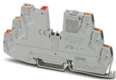
1-kanalige, elektronische Sicherung zum Schutz von 24 V-Verbrauchern. Einfache Potenzialverteilung mit Reihenklennen aus dem System CLIPLINE complete. Mit Statusausgang, Reseteingang und elektronischer Verriegelung. Zur Installation auf DIN-Tragschienen.
