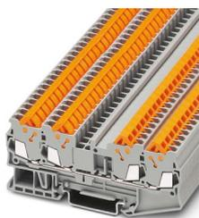
Durchgangsklemme, Nennspannung: 800 V, Nennstrom: 17,5 A, Anzahl der Anschlüsse: 4, Anschlussart: Schnellanschluss, 1. Etage, Bemessungsquerschnitt: 1,5 mm<sup>2</sup>, Querschnitt: 0,25 mm<sup>2</sup> - 1,5 mm<sup>2</sup>, Montageart: NS 35/7,5, NS 35/7,5, Farbe: grau
