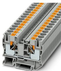
Durchgangsklemme, Nennspannung: 1000 V, Nennstrom: 57 A, Anzahl der Anschlüsse: 2, Anschlussart: Push-in-Anschluss, Bemessungsquerschnitt: 10 mm<sup>2</sup>, Querschnitt: 0,5 mm<sup>2</sup> - 16 mm<sup>2</sup>, Montageart: NS 35/7,5, NS 35/15, Farbe: grau
