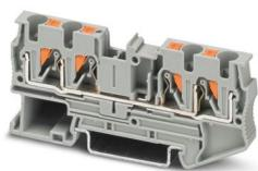
Durchgangsklemme, Nennspannung: 800 V, Nennstrom: 32 A, Anzahl der Anschlüsse: 4, Anschlussart: Push-in-Anschluss, Bemessungsquerschnitt: 4 mm<sup>2</sup>, Querschnitt: 0,2 mm<sup>2</sup> - 6 mm<sup>2</sup>, Montageart: NS 35/7,5, NS 35/15, Farbe: grau
