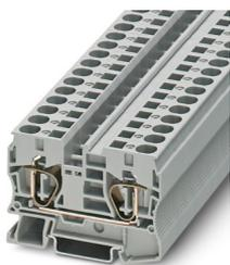
Durchgangsklemme, Nennspannung: 1000 V, Nennstrom: 57 A, Anzahl der Anschlüsse: 2, Anschlussart: Zugfederanschluss, Bemessungsquerschnitt: 10 mm<sup>2</sup>, Querschnitt: 0,2 mm<sup>2</sup> - 16 mm<sup>2</sup>, Montageart: NS 35/7,5, NS 35/15, Farbe: grau
