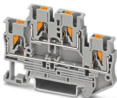
Doppelstockklemme, Nennspannung: 500 V, Nennstrom: 22 A, Anschlussart: Push-in-Anschluss, 1. und 2. Etage, Bemessungsquerschnitt: 2,5 mm<sup>2</sup>, Querschnitt: 0,14 mm<sup>2</sup> - 4 mm<sup>2</sup>, Montageart: NS 35/7,5, NS 35/15, Farbe: grau
