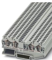
Durchgangsklemme, Nennspannung: 800 V, Nennstrom: 32 A, Anzahl der Anschlüsse: 4, Anschlussart: Zugfederanschluss, 1. Etage, Bemessungsquerschnitt: 4 mm<sup>2</sup>, Querschnitt: 0,08 mm<sup>2</sup> - 6 mm<sup>2</sup>, Montageart: NS 35/7,5, NS 35/15, Farbe: grau
