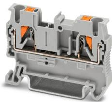
Durchgangsklemme, Nennspannung: 800 V, Nennstrom: 24 A, Anzahl der Anschlüsse: 2, Polzahl: 1, Anschlussart: Push-in-Anschluss, Bemessungsquerschnitt: 2,5 mm<sup>2</sup>, Querschnitt: 0,14 mm<sup>2</sup> - 4 mm<sup>2</sup>, Montageart: NS 35/7,5, NS 35/15, Farbe: grau
