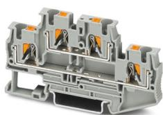
Doppelstockklemme, Nennspannung: 500 V, Nennstrom: 28 A, Anschlussart: Push-in-Anschluss, 1. und 2. Etage, Bemessungsquerschnitt: 4 mm<sup>2</sup>, Querschnitt: 0,2 mm<sup>2</sup> - 6 mm<sup>2</sup>, Montageart: NS 35/7,5, NS 35/15, Farbe: grau
