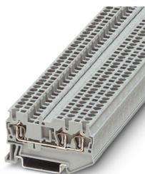
Durchgangsklemme, Nennspannung: 800 V, Nennstrom: 24 A, Anzahl der Anschlüsse: 3, Anschlussart: Zugfederanschluss, Bemessungsquerschnitt: 2,5 mm<sup>2</sup>, Querschnitt: 0,08 mm<sup>2</sup> - 4 mm<sup>2</sup>, Montageart: NS 35/7,5, NS 35/15, Farbe: grau
