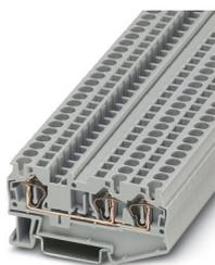
Durchgangsklemme, Nennspannung: 800 V, Nennstrom: 32 A, Anzahl der Anschlüsse: 3, Anschlussart: Zugfederanschluss, Bemessungsquerschnitt: 4 mm<sup>2</sup>, Querschnitt: 0,08 mm<sup>2</sup> - 6 mm<sup>2</sup>, Montageart: NS 35/7,5, NS 35/15, Farbe: grau
