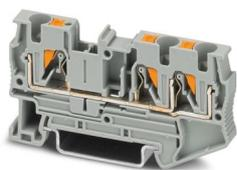
Durchgangsklemme, Nennspannung: 800 V, Nennstrom: 32 A, Anzahl der Anschlüsse: 3, Anschlussart: Push-in-Anschluss, Bemessungsquerschnitt: 4 mm<sup>2</sup>, Querschnitt: 0,2 mm<sup>2</sup> - 6 mm<sup>2</sup>, Montageart: NS 35/7,5, NS 35/15, Farbe: grau
