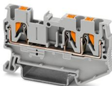
Durchgangsklemme, Nennspannung: 800 V, Nennstrom: 24 A, Anzahl der Anschlüsse: 3, Anschlussart: Push-in-Anschluss, Bemessungsquerschnitt: 2,5 mm<sup>2</sup>, Querschnitt: 0,14 mm<sup>2</sup> - 4 mm<sup>2</sup>, Montageart: NS 35/7,5, NS 35/15, Farbe: grau
