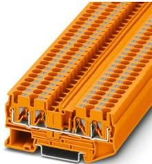
Durchgangsklemme, Nennspannung: 800 V, Nennstrom: 32 A, Anzahl der Anschlüsse: 4, Anschlussart: Push-in-Anschluss, Bemessungsquerschnitt: 4 mm<sup>2</sup>, Querschnitt: 0,2 mm<sup>2</sup> - 6 mm<sup>2</sup>, Montageart: NS 35/7,5, NS 35/15, Farbe: orange
