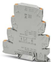
Klemme zur Filterung von Testpulsen sicherer Halbleiterausgänge mit einstellbaren Filterwerten (1,5  $\mu$ F/11,5  $\mu$ F), sowie zur EMV Filterung von 24 V-Signalen bis zu einer Stromstärke von 2 A.
