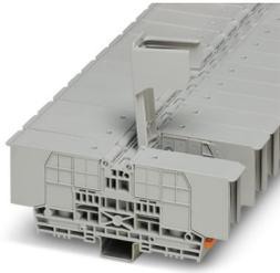
Bolzenanschlussklemme, Nennspannung: 1000 V, Nennstrom: 125 A, Anzahl der Anschlüsse: 2, Polzahl: 1, Anschlussart: Bolzenanschluss, 1. Etage, Bemessungsquerschnitt: 35 mm<sup>2</sup>, Querschnitt: 2,5 mm<sup>2</sup> - 35 mm<sup>2</sup>, Montageart: NS 35/7,5, NS 35/15, Farbe: grau
