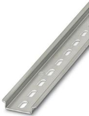
Tragschiene gelocht, Verpackungsvariante mit 25 Stück (50 m), nach EN 60715, Material: Stahl, verzinkt, dickschichtpassiviert, Standardprofil, Farbe: silber
