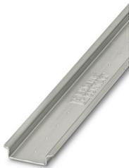
Tragschiene ungelocht, Verpackungsvariante mit 25 Stück (50 m), nach EN 60715, Material: Stahl, verzinkt, dickschichtpassiviert, Standardprofil, Farbe: silberfarben
