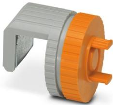
Die optionale Haltevorrichtung bietet der Rogowski-Spule sicheren Sitz auf Stromschienen mit einer Stärke von 10 ... 15 mm. Bei der Installation wird das Spulengehäuse auf den Flansch der Haltevorrichtung geschoben und verrastet automatisch.
