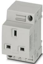
Steckdose, Steckgesicht Typ G, Schraubanschluss, für Großbritannien und weitere Länder, mit erweitertem Berührungsschutz / Shutter, Leuchtanzeige, grau, zur Montage auf Tragschiene im Service-Interface oder Direktmontage, 250 V AC, 13 A, -20 °C, 60 °C, BS 1363-1/-2
