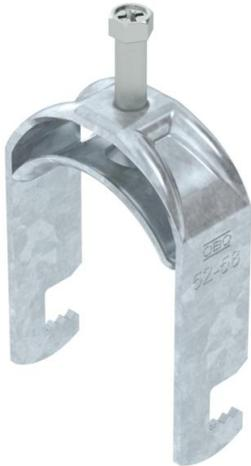
Bügelschelle mit F-Fuß, Metalldruckwanne mit gerundeten Kanten für Kabelschutz. Zur vertikalen und horizontalen Montage von 1 Einzelkabel an Flacheisen. Mit 1-gängiger Schraube an Druckwanne, universeller Sechskant-Schraubenkopf SW10, mit Schlitz und Kreuzschlitz. Geeignet für Montage im Innen- und Außenbereich. Der Einsatz einer Gegenwanne wird empfohlen.
