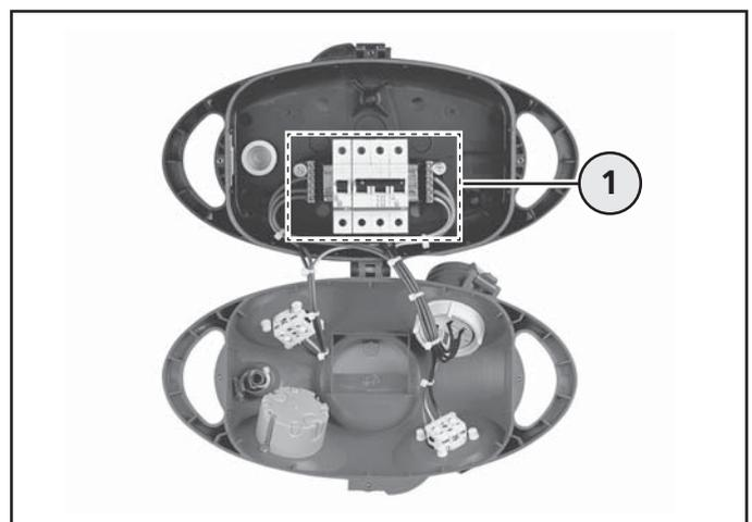
Zuleitung entfernen (Beispiel: AirKRAFT®)
