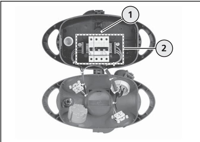
Zuleitung anschließen (Beispiel: AirKRAFT®)
