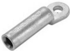
Fließgepresste Ausführung, längsdicht, für Aluminiumseile RM nach DIN 48201 und Aluminiumleiter RM/SM/RE und SE nach DIN VDE 0295.
