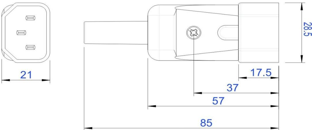
Abisolierung / Wire stripping: N 20 mm L 20 mm PE 40 mm
