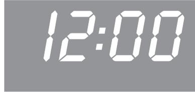
Nach dem Anschluss an das Elektronetz leuchtet *12:00* im Display und
